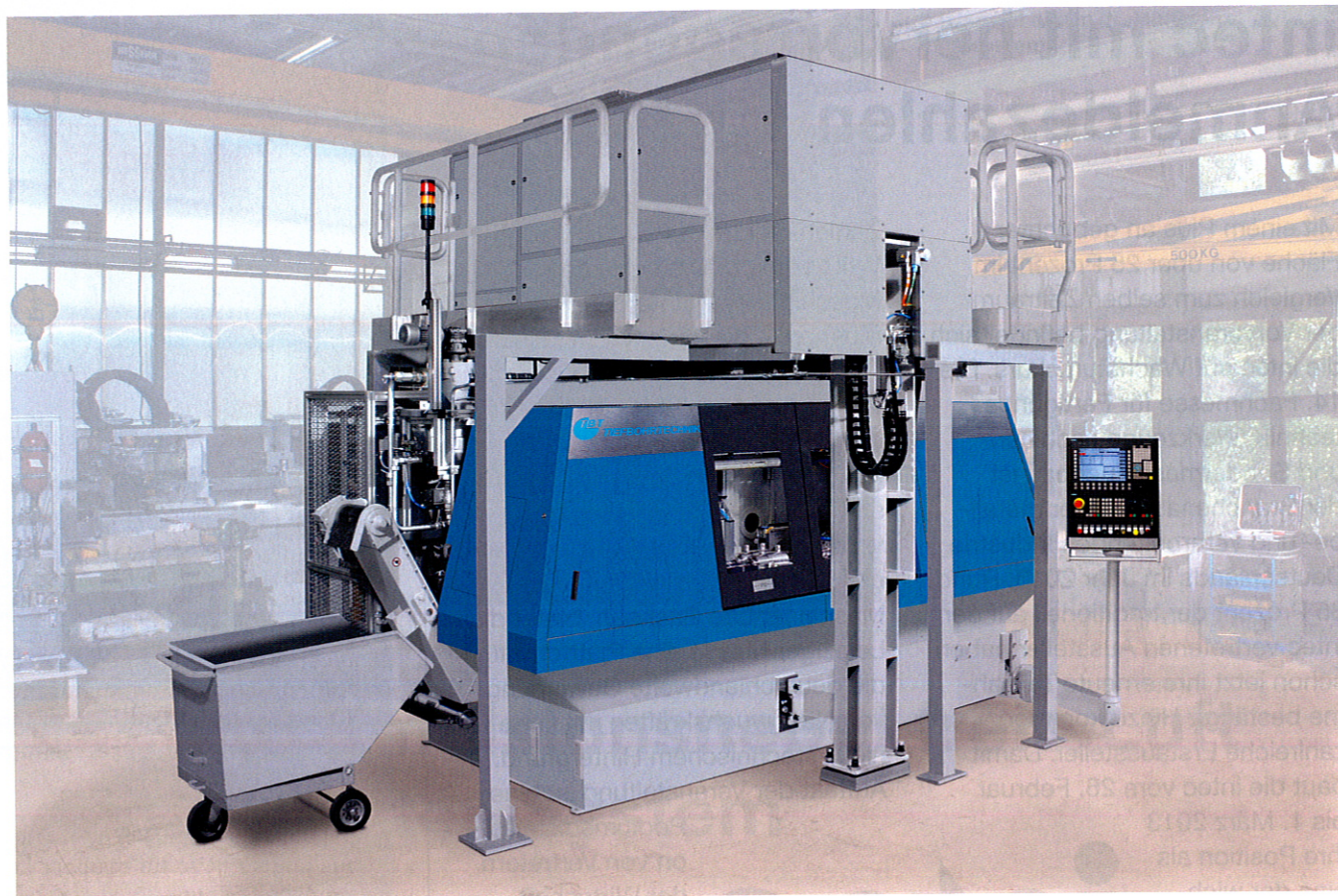
Bild: Horizontale Tiefbohrmaschine mit aufgesetztem, optionalem Werkzeugwechsler für einen mannlosen Betrieb (Werkbild: TBT Tiefbohrtechnik, Dettingen/Erms)
